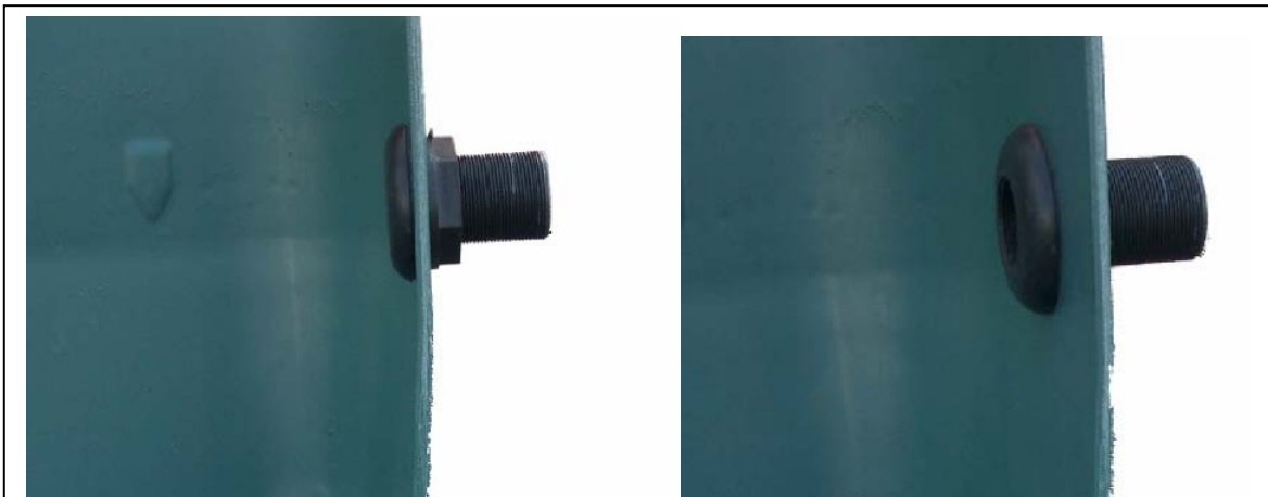
Corte de un depósito con un racor instalado (rosca de 2" macho y 1"½ hembra).
