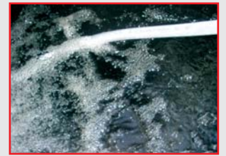
Burbujas en superficie Interior depósito digestor Micro-Step
