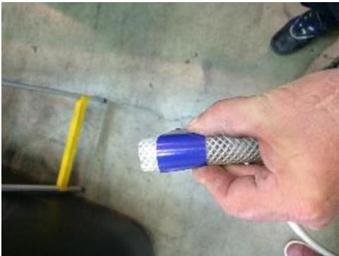
Imagen 6 Manguera que se conectará a la identificada en color azul del Air-Lift
