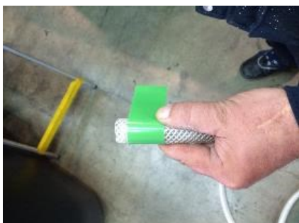
Imagen 2 Manguera que se conectará a la identificada en color verde del Air-Lift
