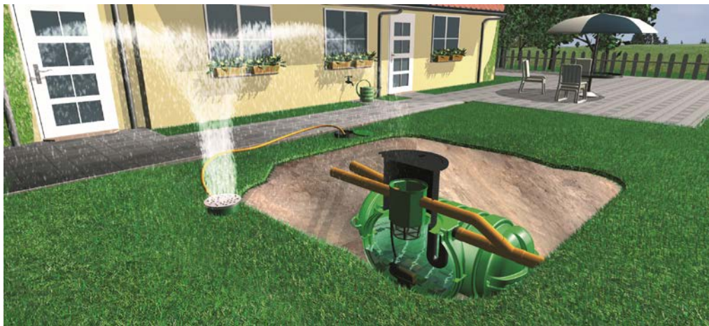
Figura 6 Sistema de aprovechamiento de agua de lluvia para riego de jardín.
